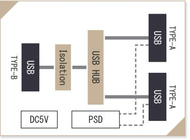
危険電圧又は低漏洩耐除細動接続を制御する産業機器や医療機器、オーディオ機器、現金を扱う券売機、精算機、チャージ機、販売機など様々な機器の接続で絶縁が必要になる USB ハブ要件のソリューションとして使用していただけます。
